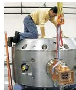
Magnete SC di Mevion (15 Ton, Synchrocyclotron).
